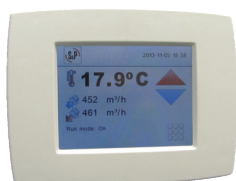
Bedienung über Touchdisplay ETD (im Lieferumfang - Kabellänge 10 m, RJ10 Stecker max. Länge 50m)
