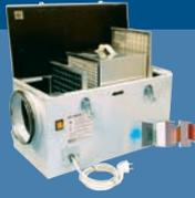
Höheren Komfort und reine Luft für Allergiker bietet der separate elektrostatische Pollenfilter AF400. Er filtert selbst winzige Schmutzpartikel aus der Luft, wie zum Beispiel Ruß oder Feinstaub. Sein Aktivkohlefilter beseitigt auch viele unangenehme Gerüche. Der Einbau erfolgt direkt in der Zuluftleitung hinter dem Lüftungsgerät.
