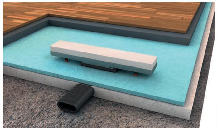
**Dämmschicht:** Die Dämmschicht wird entsprechend Estrichhöhe unterhalb der Oberkante Bodenwanne aufgebracht.
