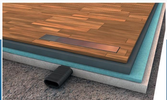
Polystyrolstreifen entnehmen, höhenverstellbaren Blendeneinsatz in die Bodenwanne einlegen und ausrichten – fertig. Der gewünschte Bodenbelag kann nun auf dem Estrich aufgebracht werden und bildet so eine flächenbündige Einheit mit der Design-Blende.
