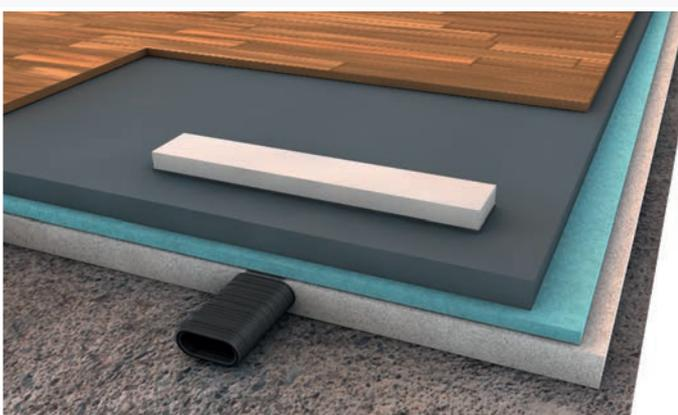
**Estrich:** Der Estrich wird bündig mit der Oberkante der Bodenwanne verarbeitet. Umlaufend um die Bodenwanne und den Polystyrolblock kann ein Dämmstreifen angebracht werden.
